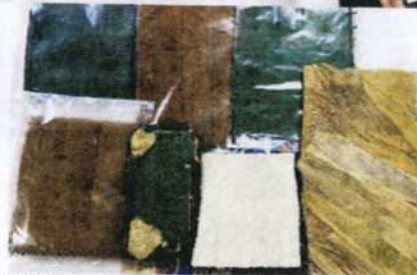
INOVASI Column ini gentian yang diperbuat daripada daun nanas, petola dan hampas kelapa yang berfungsi menghalang hakisan dan bertindak sebagai baja.
